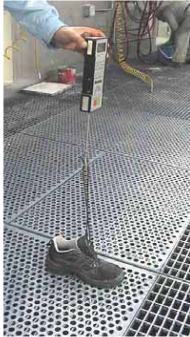
Fig. 3 – Ilustração de uma parte do protocolo utilizado para avaliar a aderência do calçado com um dinamômetro.
